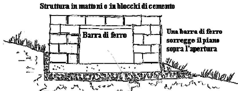
Particolare cura dovrà essere posta nella realizzazione del piano orizzontale di sostegno. Potrà essere costituito da uno strato di calcestruzzo leggero ed isolante ottenuto miscelando cemento Portland con vermiculite o altro inerte simile, dello spessore di almeno 10/12 cm, ricoperto poi da uno strato di qualche centimetro di comune malta di sabbia e cemento.
