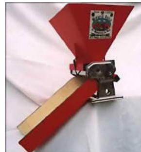
Si rimonta la macchina escludendo solo due lame che - nella parte inferiore - servono a ripulire i rulli dalla pasta. Si costruisce poi una tramoggia con del compensato da 5 mm, fissata al corpo macchina (ad esempio con due elastici ricavati da camere d'aria di bicicletta). Lo scivolo non è fissato, in quanto si appoggia nell'incavo sotto la testa della macchina e scende per gravità.
